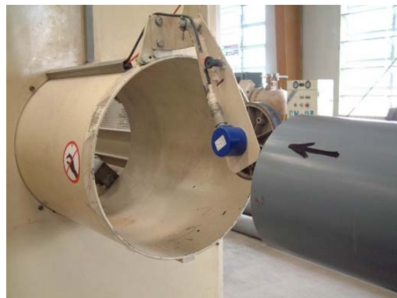
Hình 2. Vị trí mà bộ phận đo có thể hư do ống nhựa đung vào
