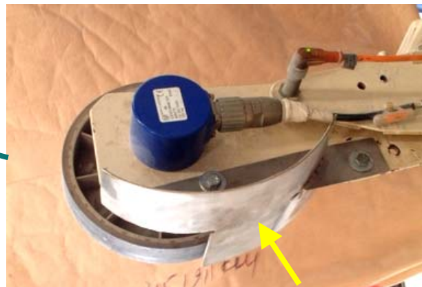
Hình 4. Tấm chắn được gắn thêm
